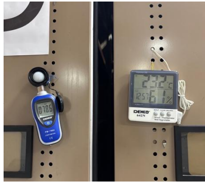
Gambar 11. Pengaturan cahaya dan suhu ruang arsip
